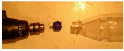
Die Flasche wird mit dem Deckel, worin eine Gewindestange mit Unterlegscheiben und Muttern geschraubt ist, an dem Akkuschrauber befestigt. Somit kann sich die Flasche frei drehen.
