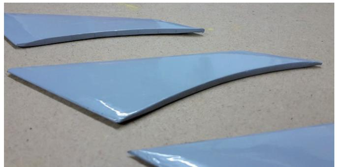
**WICHTIG** wird auf einer Fläche zu lange an einer Stelle gebügelt, so kann sich die Finne durch das Spannen der Folie verbiegen! Das geht bei 1 mm Finnen besonders schnell.
