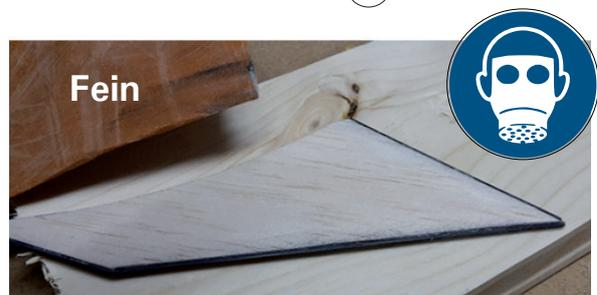
Drei Finnen mit fertiger CFK-Kante. Es ist ein gleichmäßiger Übergang von der Fläche zur CFK-Kante.
